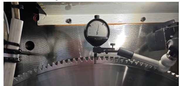
Bild 1: Vermessung des Rundlaufs am Zahnrad des Gegendruckzylinders
